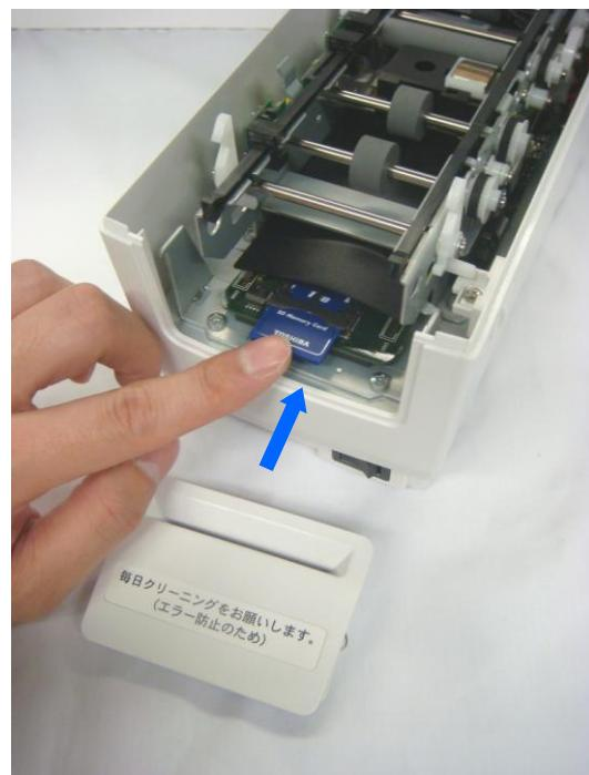
カード先端を軽く奥へ押しますとカチッと音がして少し先端部が出てきますので抜き取ります。
