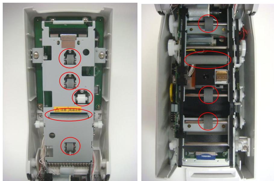
クリーニングペンを使用してサーマルヘッド・磁気ヘッドおよびローラーの計10箇所をクリーニングして下さい。
